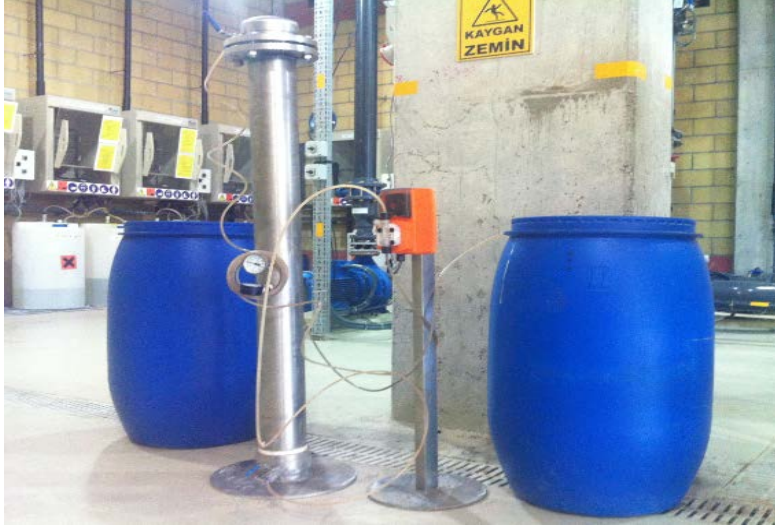
Şekil 3. Sabit aktif karbon kolon adsorpsiyon deney düzeneği görünümü
