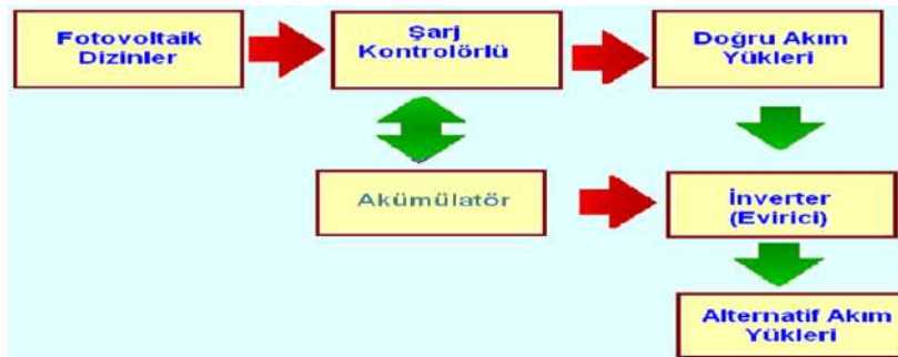
Şekil 3. Fotovoltaik sistemin blok şeması
