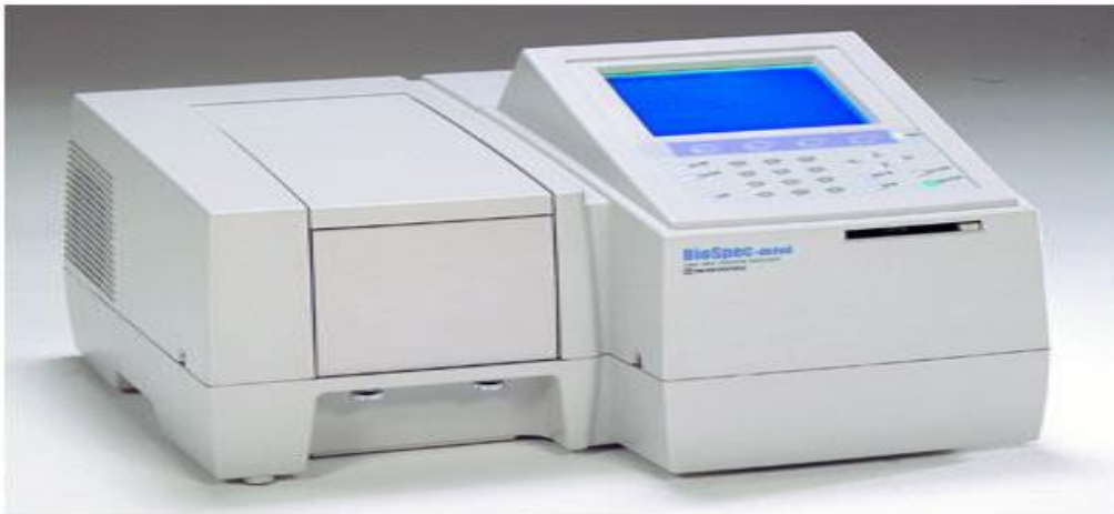
Şekil 2. Çalışmamızda kullandığımız UltraViyole -VIS mini 1240 SHIMADZU marka Spektrometre cihazı.
